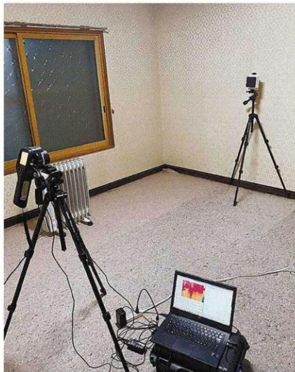
J建築システムなどが開発した断熱診断システム。赤外線カメラの画像を通して壁の温度変化を測定する(同社提供)
